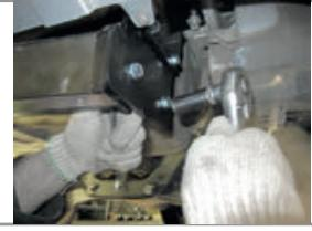
**ШАГ 5.** Установите съемный шар в сборе и закрепите его пальцем гнутым со шплинтом пружинным игольчатым. Затяните шар ключом на 38 мм. Установите фиксирующий болт M10x20 снизу, он используется для исключения технологических люфтов съемного шара и только в ненагруженном состоянии! Перед сцепкой болт демонтировать!
